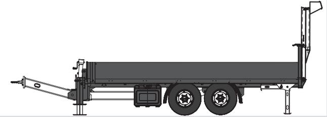
**TPS Bau mit Heckanschragung**
