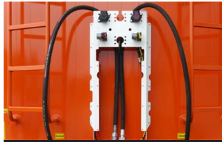
Leitungen – Anschlussblech vorne
