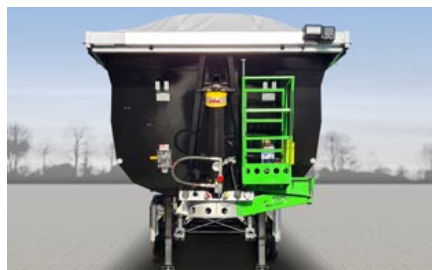
Klapp- und schwenkbares Stehpodest S.T.E.P.
