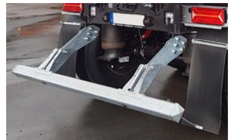
Unterfahrschutz in Asphaltausführung
