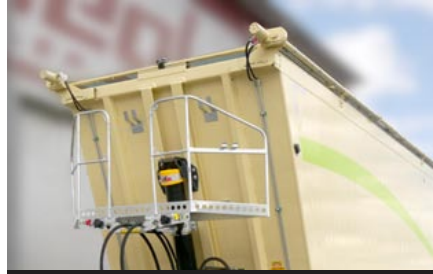
Klappverdeck mit Netzplane, Aufstieg mittig
