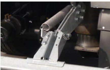
Unterfahrschutz mit Federunterstützung
