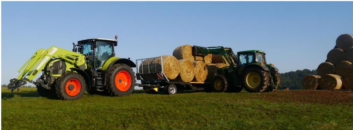
Die ca.900 mm hohe Ladefläche ist mit einem 70 mm Weichholzboden belegt. Spezielle Trocknungsbleche zwischen den Holzbohlen halten den Bohlenabstand konstant und gewährleisten, dass das Holz trocknen kann. Die seitlich verschiebbaren Auffahrrampen sind feuerverzinkt, 2800 mm lang und 750 mm breit und lassen sich mit Hilfe einer Federheber-Unterstützung komfortabel handhaben.
