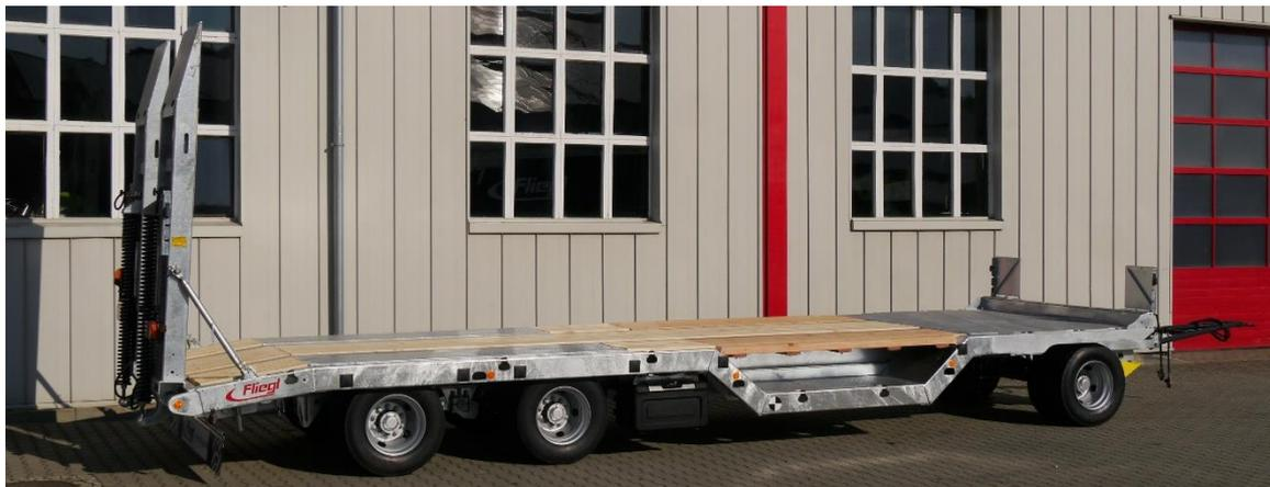
Unangetastet bleibt die Spezialkonstruktion des Stahlchassis, die dem Prinzip Nutzlast & Nachhaltigkeit folgt. Schwimmend gelagerte Rahmen-Querträger, ausgeführt als Doppel-T und Kastenprofile, sind im Abstand von 280 bis 400 mm angeordnet. Der DTL Agrar ist somit extrem verwindungssteif und biegefest. Er bietet eine sehr hohe Nutzlast und transportiert bis zu 22 Tonnen problemlos. Das Leergewicht liegt bei ca. 8 t.
