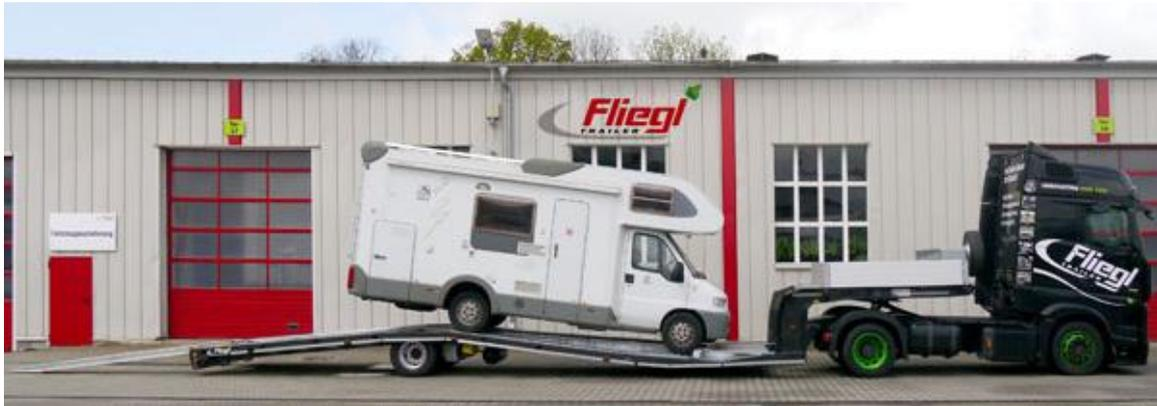
Pluspunkte sammelt der neue Fliegl SES 210 Spezial auch mit seinem einfachen und sicheren Handling: Die Seilwinde mit einer Zugkraft von 5,5 Tonnen am Hals des Satteltiefladers, deren Kraft durch Umlenkung bei Bedarf gesteigert werden kann, zieht den Truck auf den Fliegl Schatzträger.
