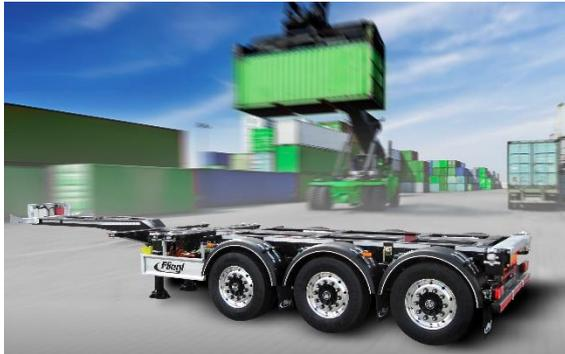
Über die Tele Controll wird die Feststellbremse der Achsen aktiviert und – ja nach Größe der Container – mit einem Handgriff die gewünschte Länge des Ausschubs gewählt. Höhenanpassungen am Heck und klappbare Mittelaufgaben ermöglichen den Containertransport ohne Tunnel.
