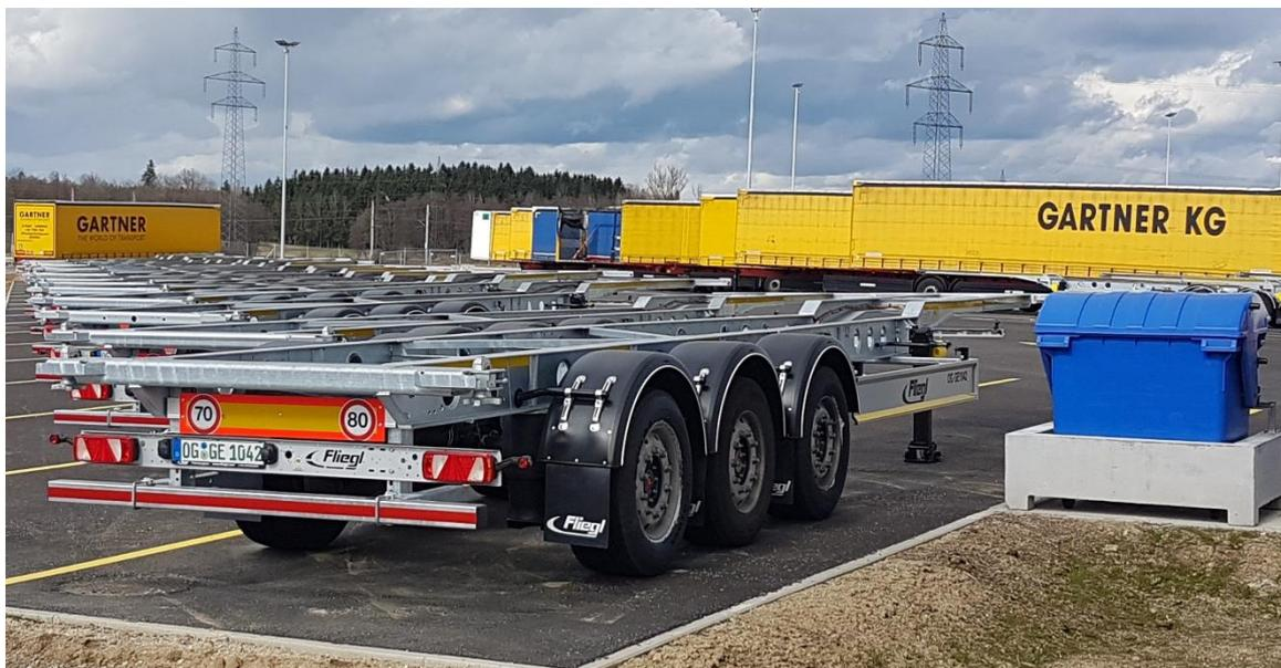
Die Dreiachs-Sattelaufleger vom Typ SDS 380 in Schwanenhalsausführung bieten dank Light-Chassis ein ausgezeichnetes Nutzlast-/Leergewicht-Verhältnis: Bei einem Leergewicht von nur etwa 4.000 Kilogramm ergibt sich eine Nutzlast von 34.000 Kilogramm.
