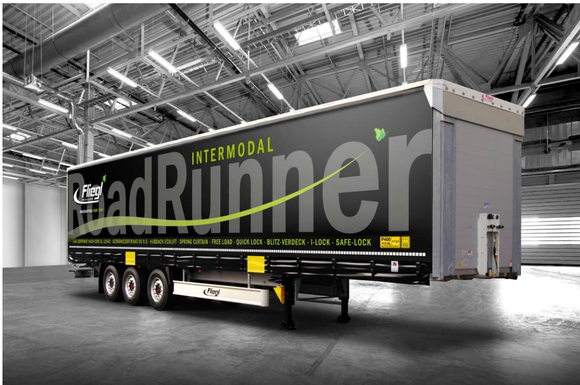
Ladungssicherung ist das A und O, daher bietet der RoadRunner Greenlight diverse Zurrmöglichkeiten: Im Bereich der Coilmulde mit 6 Coilstützen sind 18 Zurrösen mit je 5 Tonnen Zugkraft eingelassen, je zwei weitere im Längsträger vor der Coilmulde. Spanngurte lassen sich zudem in das Load-Lock-Profil, also den leicht schrägen Außenrahmen einhängen. Im Querträger
