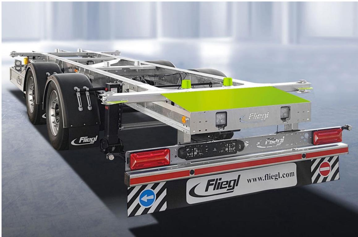
Der TWP 180 Standard bietet Aufnahmemöglichkeiten für drei verschiedene Wechselbehälter-Maße: die Containerverriegelungen auf stabilen Auslegern eignen sich für Behälter mit 7,15, 7,45 und 7,82 Meter Länge. Fliegl stattet den TWP mit drei Paar abnehmbaren Führungsrollen aus; die Swap Guard-Wechselbrückeneinweiser vor und hinter jeder Containerverriegelung erleichtern das Aufbrücken und verhindern Anfahrtschäden. Der vordere Anschlag lässt sich längs verstellen und abklappen.
