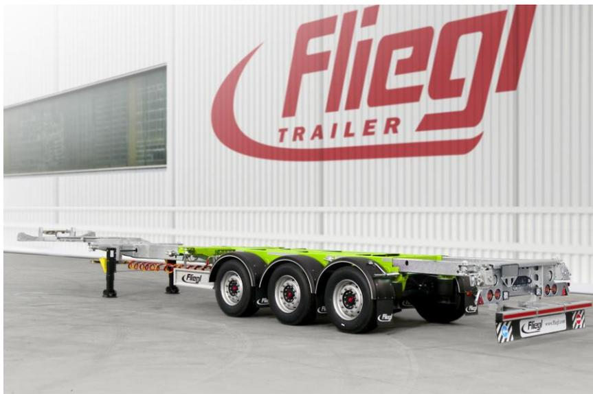
Das Mittel-Teleskop ist als ineinanderlaufender Zentralrohrrahmen mit Bolzenarretierung ausgeführt. Der niedrige Rahmenhals des Chassis entspricht der Höhe der
